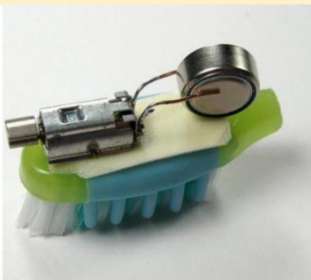
**Давайте рассмотрим вариант робота из вибромоторчика от мобильного, плоской батарейки, двустороннего скотча и ... зубной щетки.** Для того, чтобы начать делать этого простейшего робота из подручных средств, возьмите свой старый, ненужный мобильный телефон и извлеките из него вибромоторчик. После этого возьмите старую зубную щетку и отрежьте лобзиком головку.
