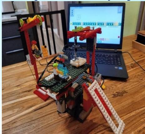
Вращающаяся платформа на электродвигателе с передачей момента вращения через шестеренчатую передачу, с размещением на платформе оператора, который следит за работой платформы.
