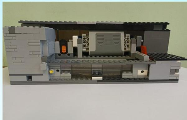
В передней части конвейера расположен «вакуумный разделитель теста», для равномерного отделения теста на равные части, вращение отделителя обеспечивает двигатель
