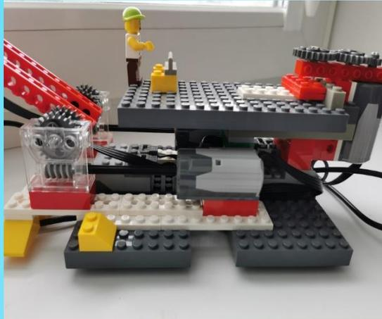
Балка миксера, с отдельного электродвигателя передает момент вращения через ременную передачу.
